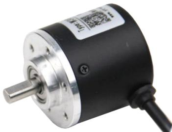
W38S6 系列磁电增量编码器采用霍尔式无触点技术，与普通的编码器相比具备良好的防水、防尘、防震动、抗机械损伤的功能，可承受较高的轴向和负载，可满足各类工业现场应用，W38S6 系列产品多种输出电路可选，先进的信号处理技术与丰富的电气输出形式相结合，可满足不同上位机应用需求。
